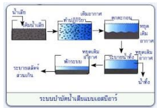
ข.ลักษณะการทำงานของถังบำบัดเอสบีอาร์
