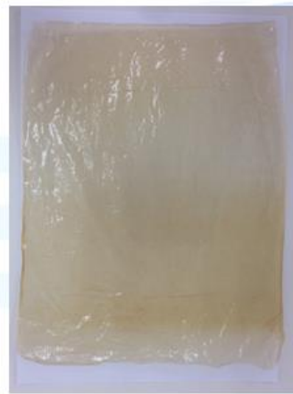
ฟิล์มต้านออกซิเดชัน (Cellulose acetate + สารสกัดมะขามป้อม) ได้ฟิล์มมีสีน้ำตาลอ่อนของสารสกัดมะขามป้อม สามารถแสดงสมบัติยับยั้งการเกิดออกซิเดชันหรือชะลอการหืนได้
