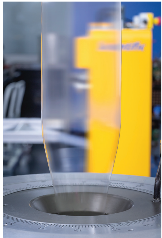
รูปที่ 5. กระบวนการเป่าขึ้นรูปฟิล์มพลาสติก ที่มา : Clariant (2025)
