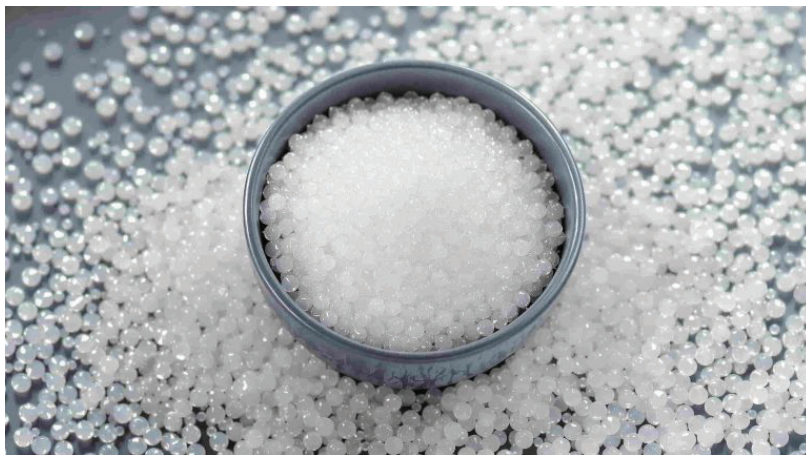
รูปที่ 6. Polymer Processing Aids (PPA) หรือ สารช่วยในกระบวนการผลิตพอลิเมอร์ ที่มา: EuP Egypt (2025)
