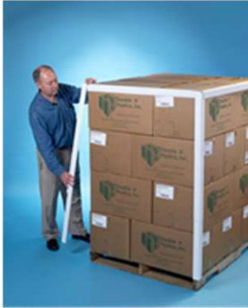
การใช้งานแผ่นเข้ามุมหรือจากกระดาษร่วมกับฟิล์มพันพาเลท
