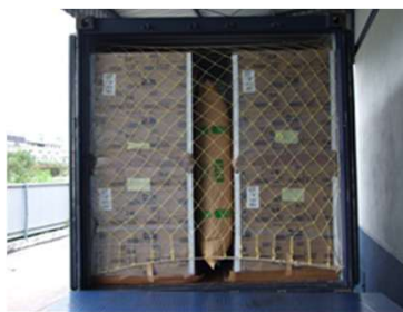
การใช้ตาข่ายป้องกันสินค้าเคลื่อนหลุดจากกอง
