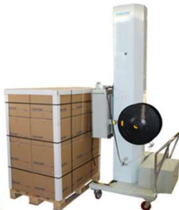
การใช้งานแผ่นเข้ามุมหรือจากกระดาษร่วมกับสายรัดกองสินค้า
