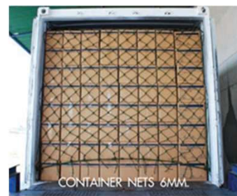
การใช้ตาข่ายป้องกันสินค้าเคลื่อนหลุดจากกอง
