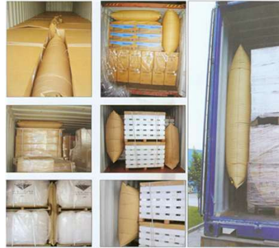
การใช้ถุงลมจำกัดการเคลื่อนที่ของสินค้า
