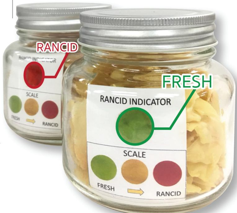
รูปที่ 3 เปรียบเทียบการเปลี่ยนสีของแผ่นชั้ดหลังเก็บในห้องทุเรียนทอดที่มีค่า PV ต่างกัน ซ้าย- บรรจุทุเรียนทอดไม่หัก/PV = 6.38 meq.O<sub>2</sub>/kg และชั้ดซึ่งมีสีเขียว
