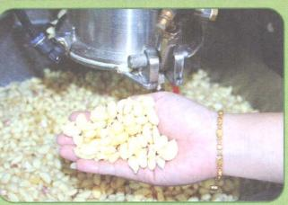
โลยีอาหาร ชี้แจงเพิ่มเติมว่า หลักการทำงาน เครื่องปอกเปลือกกระเทียม วว. อาศัยแรงลม แบบกระแสลมแปรปรวน ทำให้เกิดการขัดสี กันระหว่างกลีบกระเทียมกับกลีบกระเทียม รวมทั้งกลีบกระเทียมกับผนังด้านใน โดยนำ กระเทียมแบบกลีบใส่ลงในช่องอบลมร้อน ทางด้านบนของเครื่อง ซึ่งผู้ใช้สามารถ บรรจุกระเทียมได้มากที่สุด ครั้งละ 10 กิโลกรัม ภายในชุดอบลมร้อนนี้จะมี ตัวกระจายลมร้อนเพื่อเป่าลมร้อนให้ เปลือกกระเทียมแห้งและง่ายต่อการขัดสี
