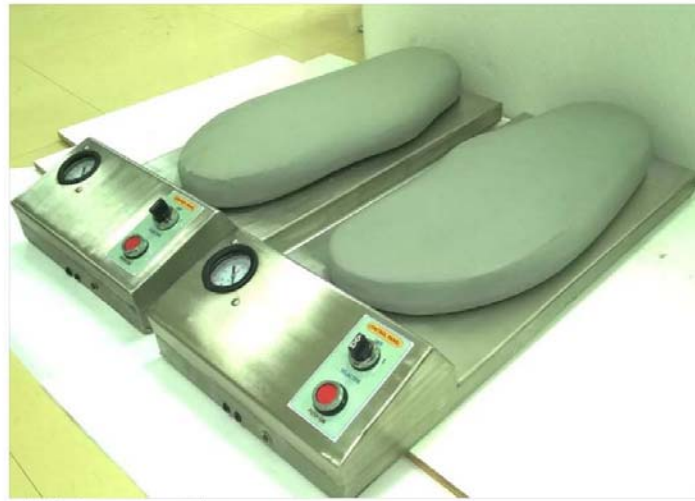
เครื่องขึ้นรูปแผ่นเสริมรองเท้าเพื่อสุขภาพ
