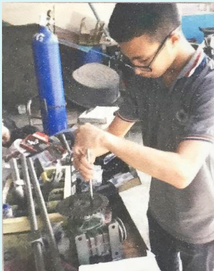
การประกอบสเตอร์เข้ากับเกียร์ทดรอบ และเครื่องทำงานยัดเส้นโรตีสายไหม
