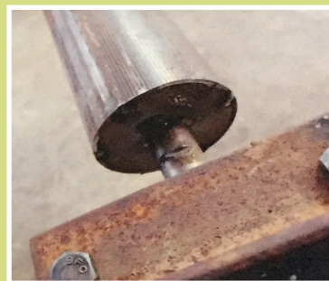
รูปที่ 2 การเชื่อม เหล็กท่อกับเพลา
