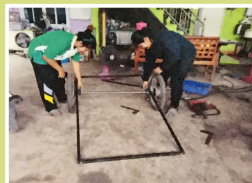
รูปที่ 4 การเชื่อม เหล็กกล่องเป็น โครงสี่เหลี่ยม
