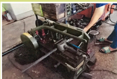
รูปที่ 3 การตัด เหล็กกล่องดำ แบ่งเป็น 3 ท่อน
