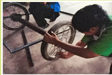
รูปที่ 8 การขันล้อเข้ากับโครงสี่เหลี่ยม
