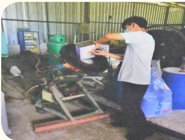
5. นำไปฉีดเข้าแม่แบบด้วยเครื่องฉีดร้อนในโรงงานของบริษัท โพลีเซฟ 2006 ภาคใต้จำกัด
