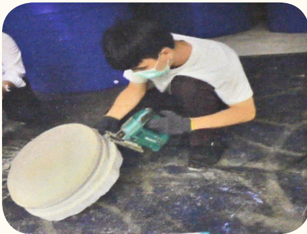
6. แกะออกจากแม่แบบและนำไปตัดแต่งให้เรียบร้อย
