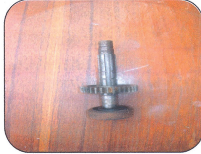
รูปที่ 2 ลูกป้อนสำหรับทำแกนหมุน
