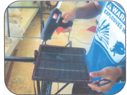
รูปที่ 9 ติดโซลาร์เซลล์เป็นตัวชาร์ต แบตเตอรี่จับมอเตอร์
