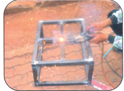
รูปที่ 3 เชื่อมลูกป้อนกับแท่นวางตุ๋บ
